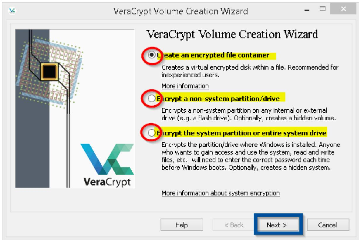
Crear un almacén encriptado (la opción que vamos a ver: Puedes crear un almacén encriptado en cualquier parte y con el tamaño que quieras; no debe pasar el tamaño total del dispositivo físico en donde se va a crear y crearlo no implica que puedas crear otros archivos visibles y sin encriptar alrededor del almacen encriptado)
